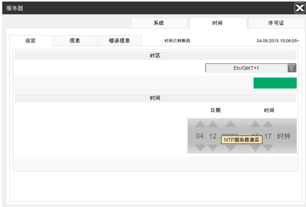
图 6-17: 仅可在没有NTP服务器的情况下设置时间
