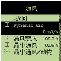
动态空气使得畜舍内空气交换合适成为可能，并处在压力变化的情况下。动态空气需要在无级排风口处安装传感器。不同/变化的的无级档输出的测量结果精确反映/对应通风系统的排风/输出。
