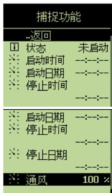
可以使用钥匙安装捕捉功能。然后，该功能只在启动和停止时段内，使用钥匙时才能启动。
