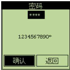
旋转旋钮直到密码的第一位数字突出显示，然后按下黑色文本框内随即出现星号 (\*)，这就表示您已选定了第一位数字
