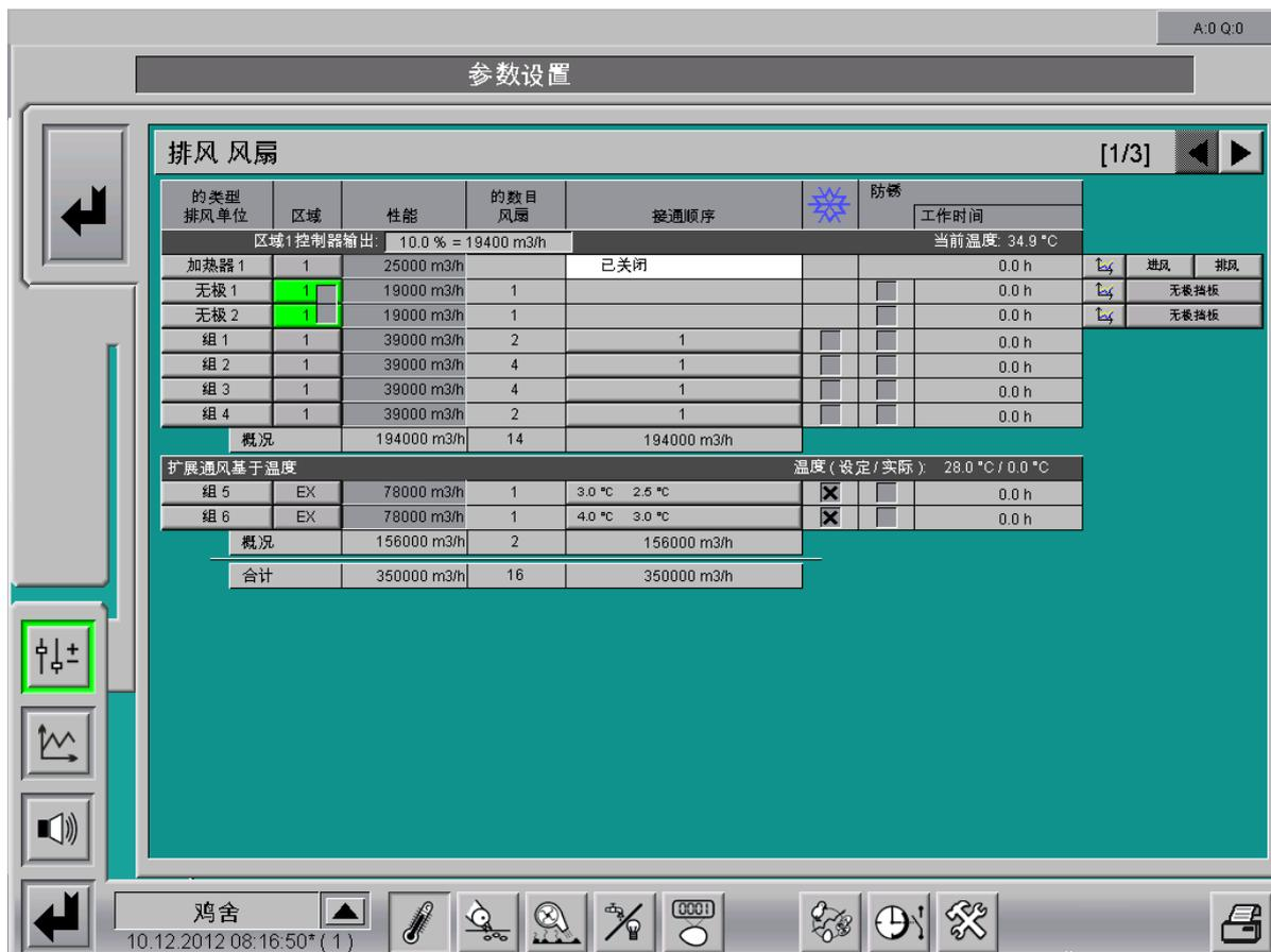
图 4-4: 两个无级变速风扇组的控制
