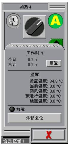
如果加热组配有加热故障信息输入，就会自动生成一个输出允许使用可视化视图通过外部释放确认信息。您可以在手动操作菜单内看到外部释放可。如果发生故障，除了报警信息以外总视图内的加热组还会呈红色闪烁状态。如果在报警设置内将报警消除，则不会显示故障。
