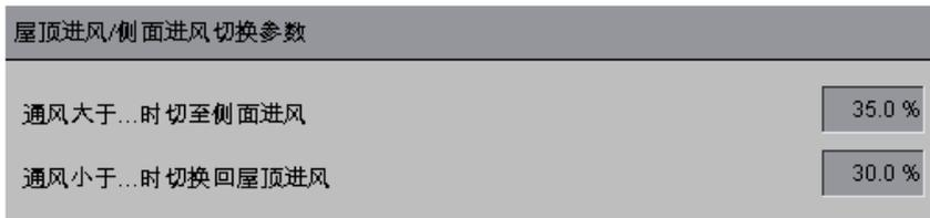
图 7-15: 侧墙 / 屋顶进风切换参数
