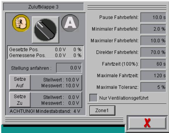
图 7-7：带反馈的模拟进风挡板
