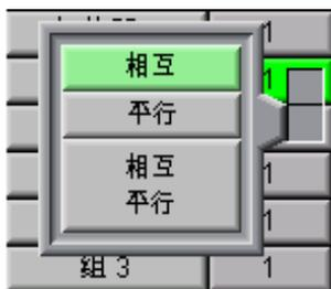
AMACS 最多可以控制 3 台无级变速风扇。如同这里可以看到的，如果安装的无级变速风扇不止一台，这些风扇的连接顺序可以是**相继**，**平行**或是**相继平行**。
