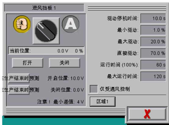
图 7-3: 继电器控制的进风挡板
