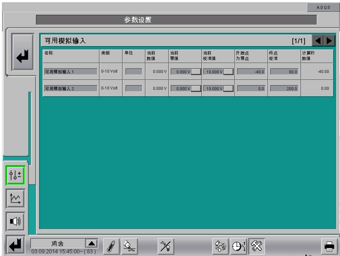
图 9-9： 可用模拟输入设置
