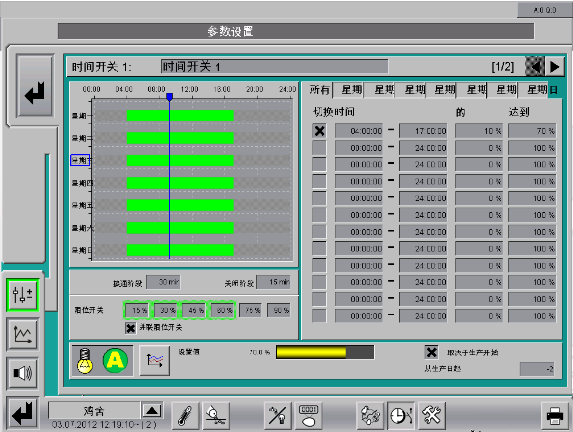
图 10-15: 模拟定时开关
