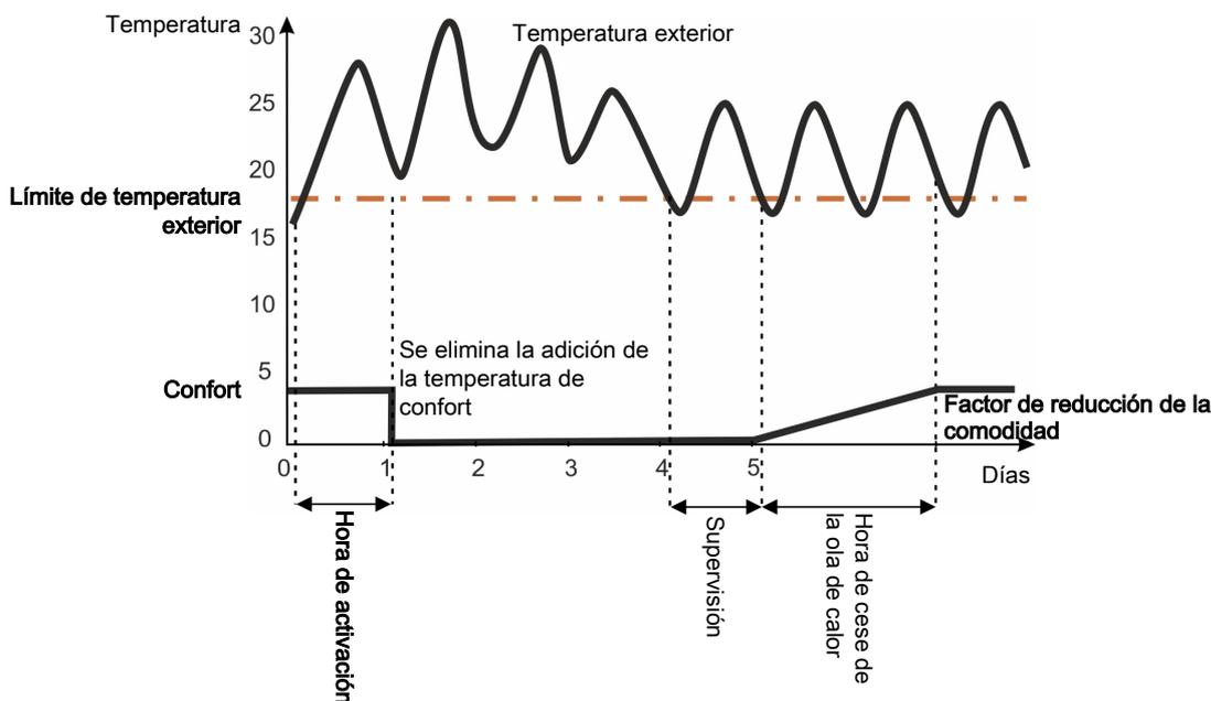
Figura 6: Confort ante ola de calor
