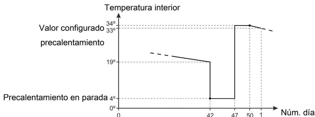
Figura 42: Ejemplo de ajuste de precalentamiento.
