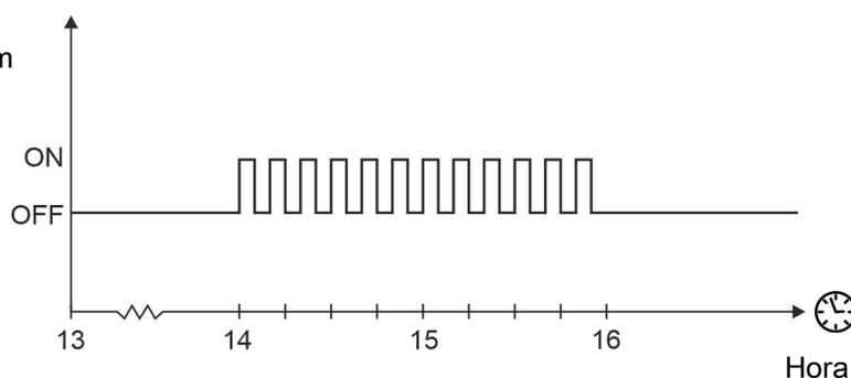
Figura 28: Control reloj 24 horas
