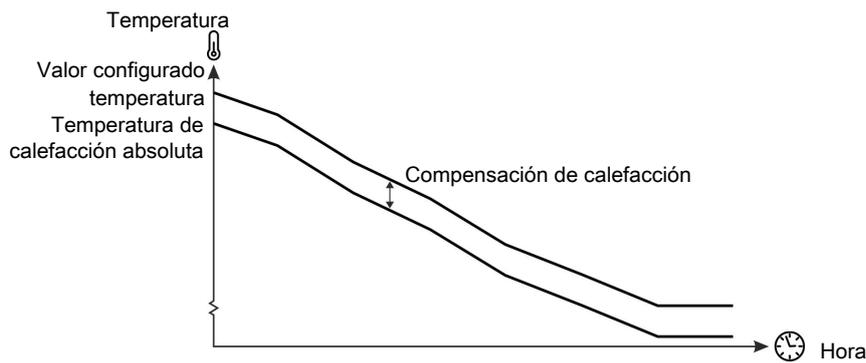
Figura 36: Establecer compensación de calefacción
