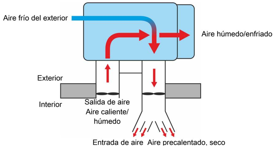
Figura 17: Ejemplo de principio de unidad recuperadora de calor.
