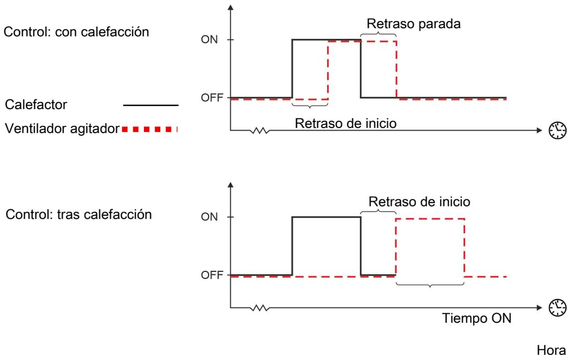
Figura 29: Regulación de la fuente de calor
