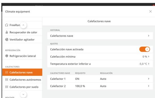
La calefacción mínima es una función que el controlador activa en condiciones de frío. La calefacción mínima puede, por ejemplo, minimizar la formación de hielo en la entrada de aire. Cuando la temperatura exterior se establezca en **Temperatura exterior inferior a**, el controlador de la nave añadirá constantemente el calor mínimo.
