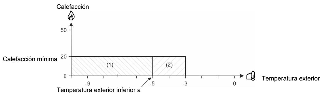
Figura 38: Calefacción mínima al reducirse o incrementarse la temperatura exterior
