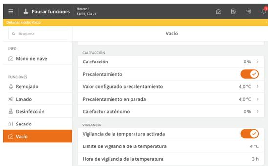
El controlador se puede asegurar contra la configuración incorrecta en el estado de la nave **Vacío**.
