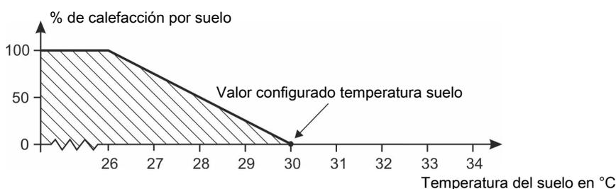
Figura 39: Calefacción por suelo con sensor de temperatura
