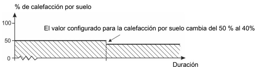
Figura 40: Calefacción por suelo sin sensor de temperatura
