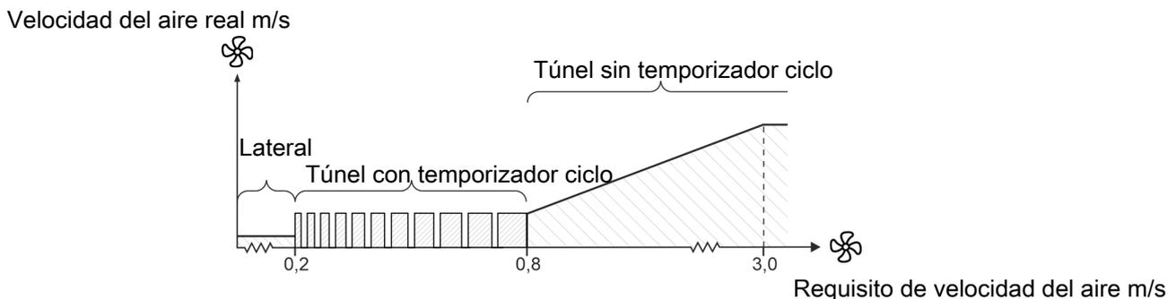
Figura 19: Secuencia de ventilación con temporizador de ciclo en la ventilación de túnel.
