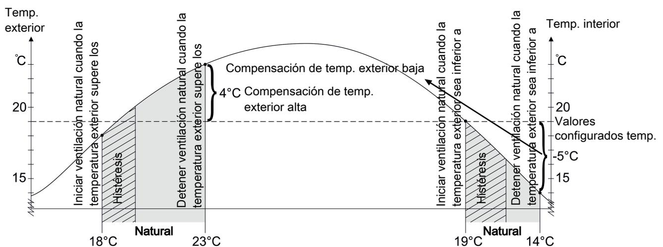
Figura 26: La ventilación natural se encuentra activa en función de la temperatura exterior actual.
