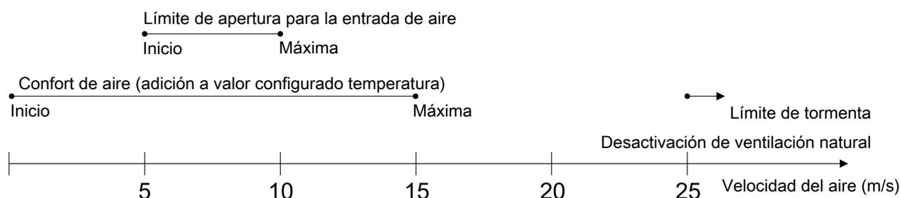
Figura 27: Ventilación natural con velocidad del aire en aumento
