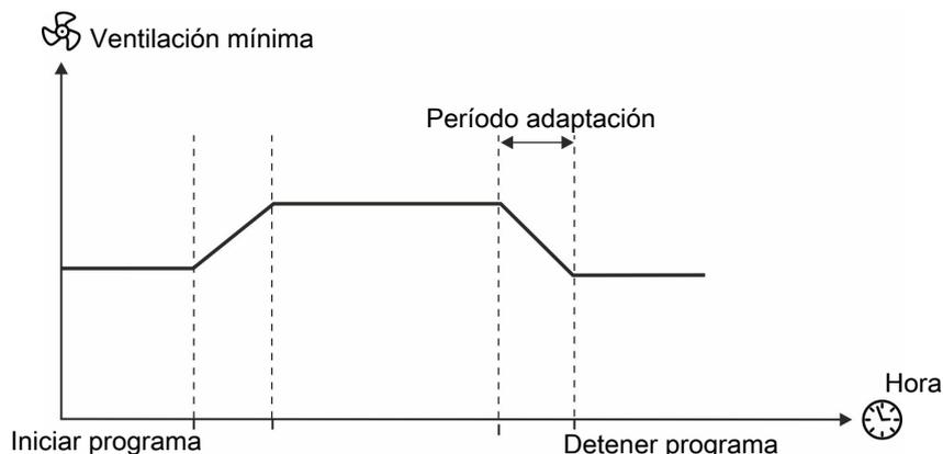
Figura 14: Adaptación gradual a la ventilación mínima. Para conseguir el efecto completo, la hora de inicio debe ajustarse a aproximadamente 30 minutos antes de entrar a la nave.
