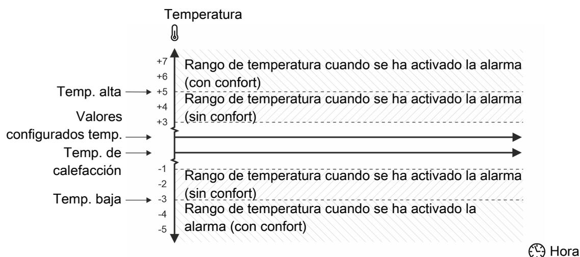
Figura 43: Alarma de temperatura alta y baja
