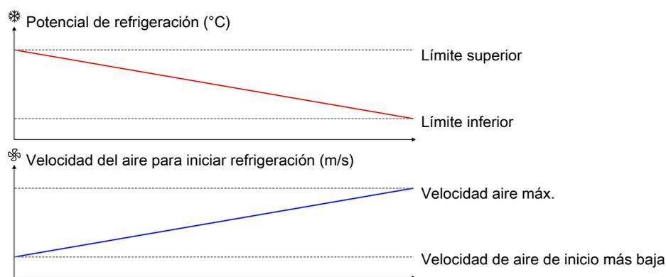
Figura 34: En áreas con baja humedad exterior y un gran potencial de refrigeración, este puede comenzar a una velocidad de aire más baja. Mientras que en áreas con bajo potencial de refrigeración, este comenzará lo más tarde posible, es decir, a la velocidad del aire máxima.
