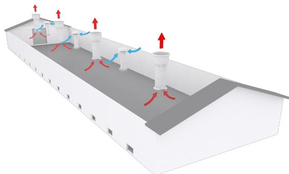
Figura 21: Ventilación FreeRange en un sistema de presión ecualizada.
