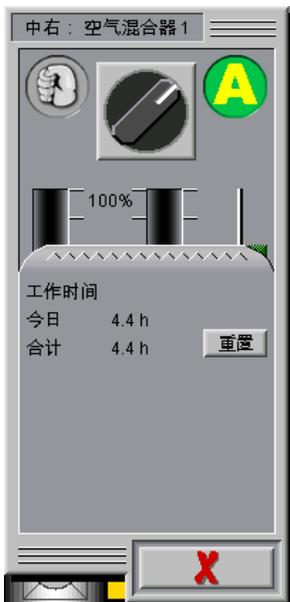
显示电机的工作时间可有助于您确定保养周期。点击高亮显示的区域打开相应组件的计时器。
