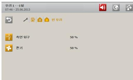
이 기능은 환기가 시스템 용량의 고정된 비율(50%)로 실행되도록 함으로써 공기의 변화를 유지합니다. 이 기능은 실수로 축사가 빈 축사로 설정되는 경우에 동물들을 보호하기 위한 것입니다.
