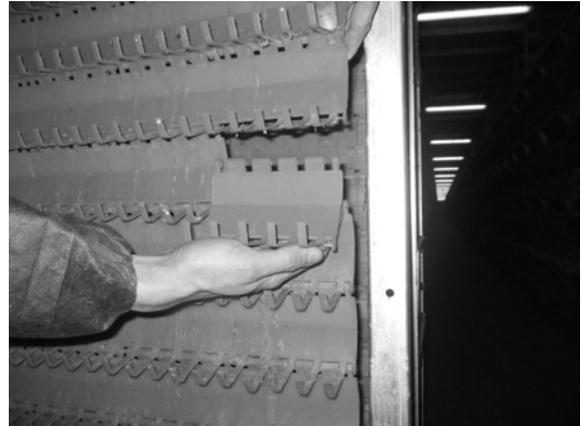
**11.** Deslice el nuevo módulo de cadena, plegado hacia atrás, con los ganchos sobre el alambre del componente situado encima.
