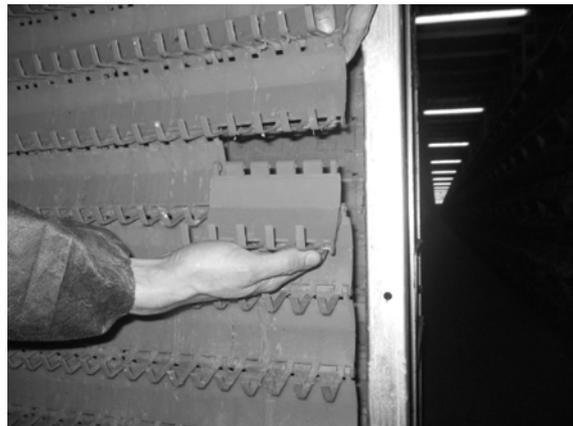
**11.** Держа откинутым назад новый цепной модуль, задвиньте его крючок на провод находящегося над ним монтажного элемента.
