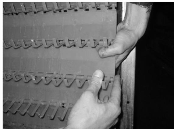
17. Проведите визуальный контроль, все ли крючки надвинуты на провода и зафиксированы.
