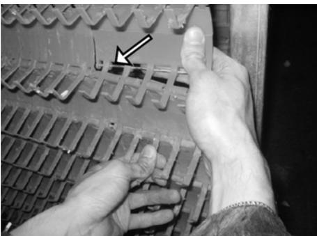
**14.** Расположите новый модуль так, чтобы крючки находящегося под ним монтажного элемента могли быть задвинуты на провод нового монтажного элемента.
