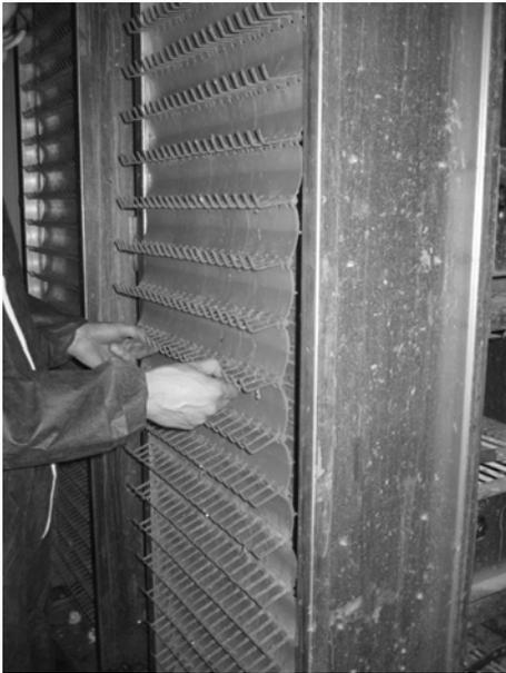
2. Ослабьте натяжение транспортировочной цепи у верхнего поворотного узла на прибл. 50 мм / 2".
