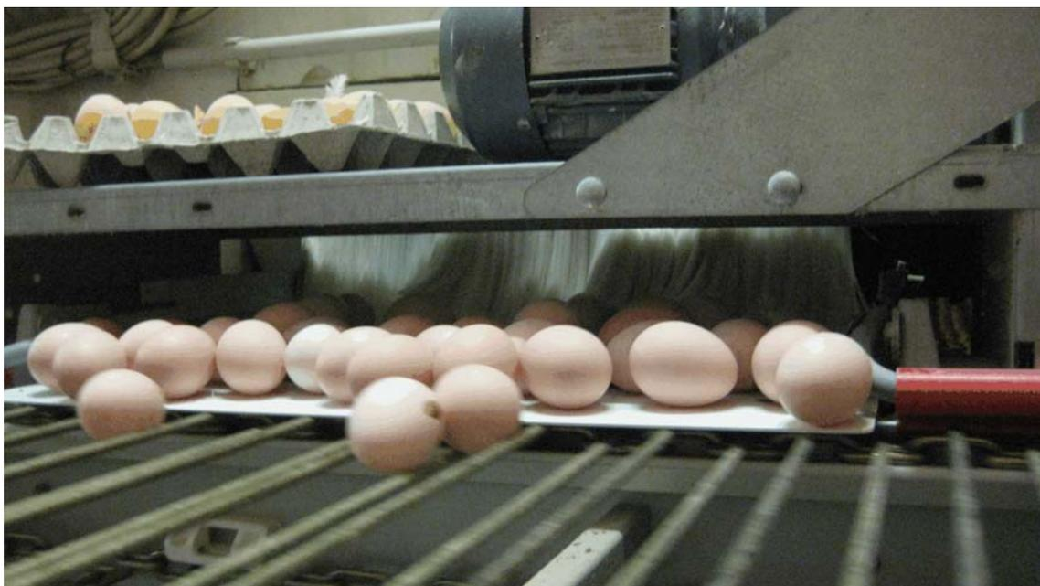
Ilustración 4-3: Traspaso del nidal al transportador transversal
