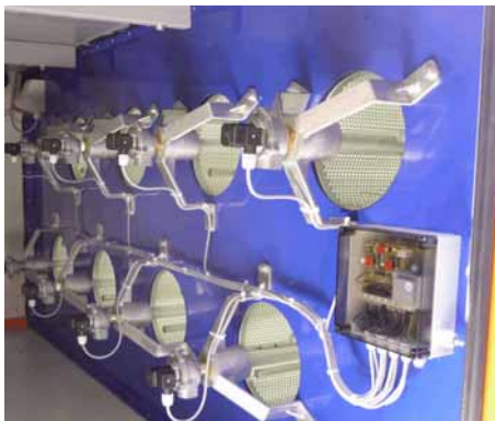
图 3-4: 电磁阀安装位置（清洁气体侧 => 9 " 术语 "）
