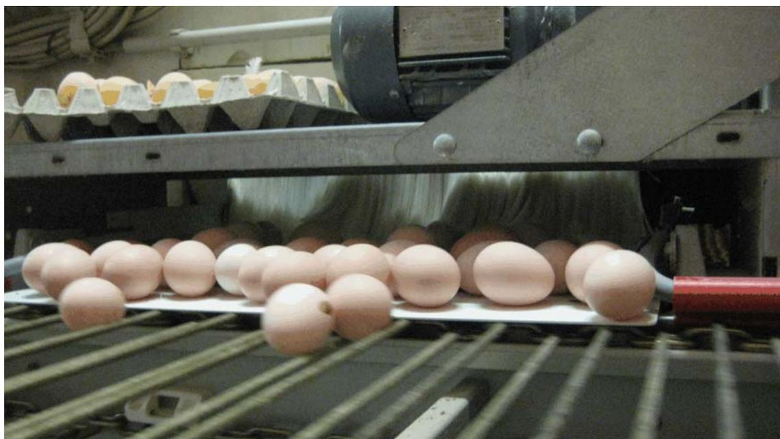
Figure 4-3 : Transition du pondoir au transporteur transversal
