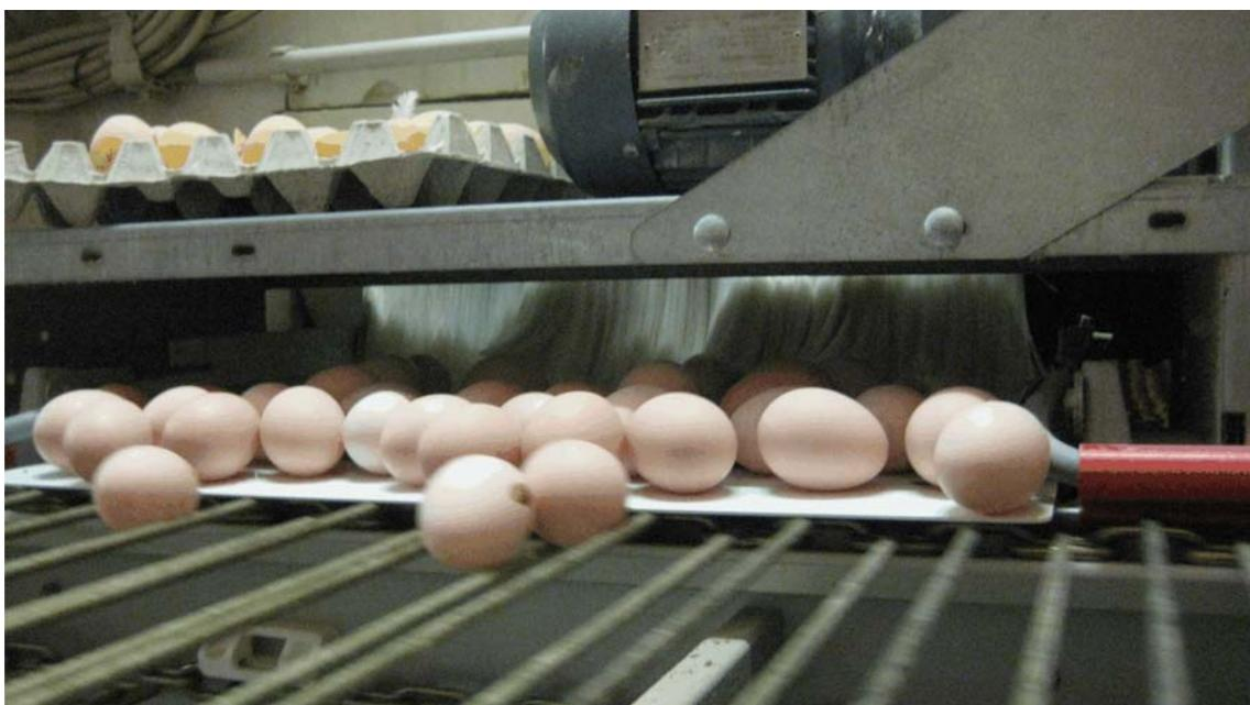
Рис. 4-3: Передача из гнезда на поперечный транспортёр
