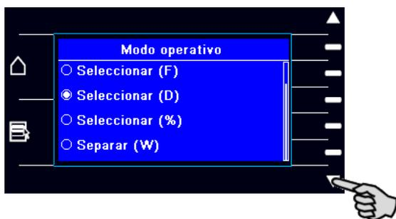
Dado que el menú "Modo operativo" tiene más de 4 entradas, debe accionar la tecla de flecha para poder seleccionar el modo "Deseleccionar (W)".
