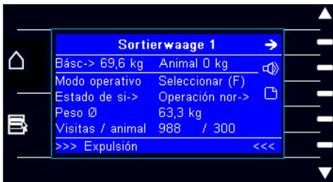
Ilustración 2-1: Pantalla principal (información acerca del estado de la estación/del peso del animal)
