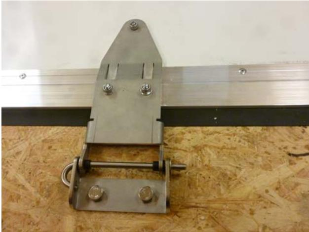
**Abb. 4:** Scharnier, montiert
