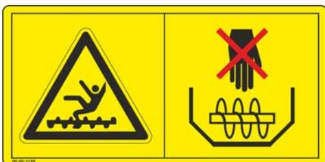
**¡Peligro de atrapamiento a causa de sinfines, cadenas o poleas de cable en funcionamiento!**
