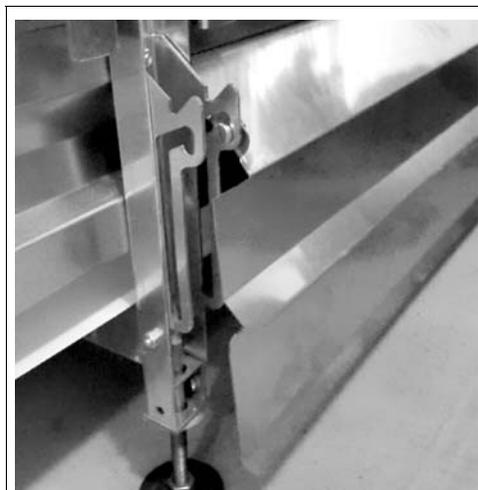
Figure 3-8 : Tôle de fermeture rabattable
