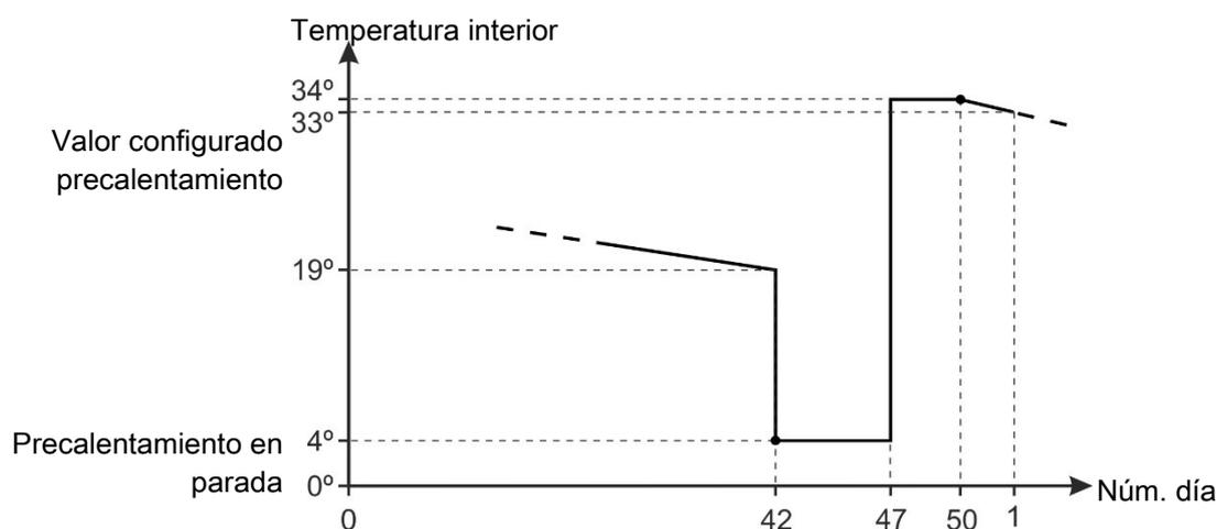
Figura 9: Ejemplo de ajuste de precalentamiento.
