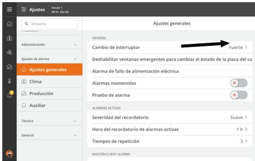
Si el controlador de la nave está conectado a un módulo de interruptor de mando, será posible establecer una alarma si la posición del mismo cambia.
