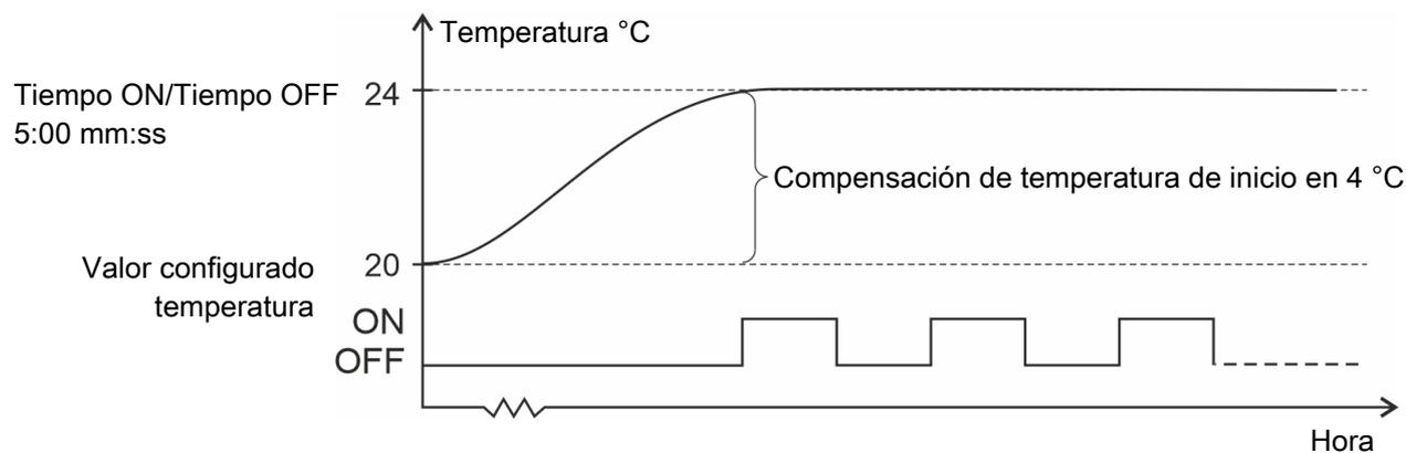
Figura 3: Ventilador agitador controlado por relé (ON/OFF) con un sensor de temperatura.
