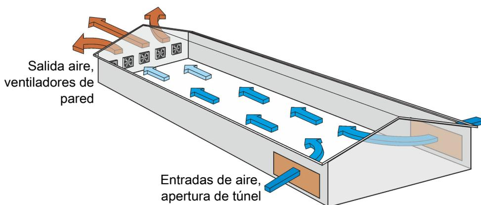
Figura 1: Principio de la ventilación tipo túnel
