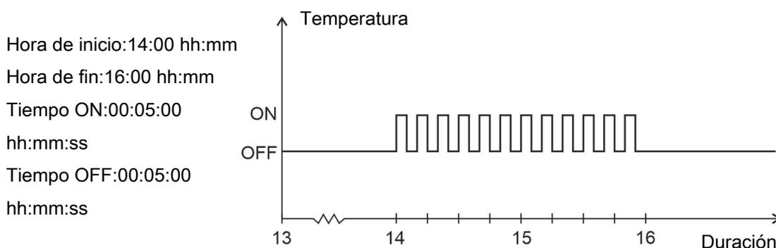
Figura 2: Control reloj 24 horas
