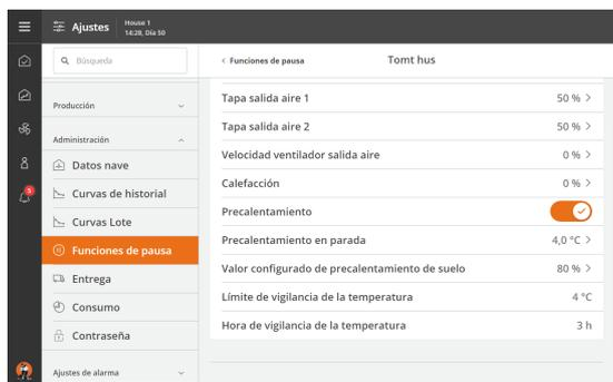
El controlador de la nave evita que la **Nave vacía** se configure incorrectamente. El controlador climático controla la temperatura en la nave durante tres horas después de cambiar el estado lote a **Nave vacía**. Si la temperatura aumenta más de 4 °C durante este periodo (indica que hay animales en la nave), el controlador de la nave activa una alarma y activa la ventilación.
