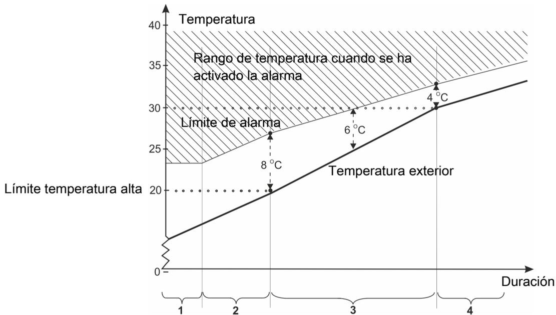
Figura 10: Temperatura de verano a 20 °C y 30 °C en el exterior
