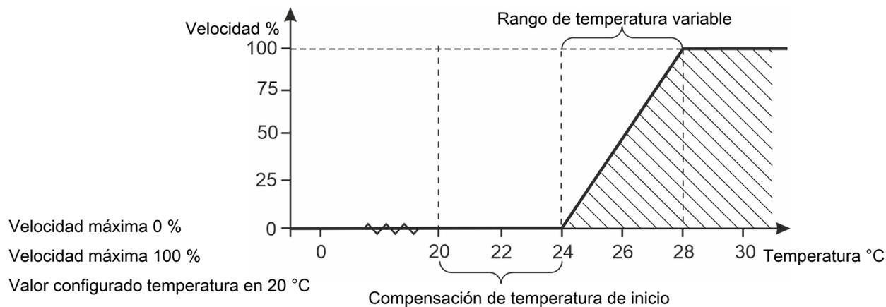
Figura 4: Ventilador agitador controlado de 0-10 V
