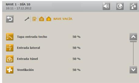
Esta función mantiene la aireación de la nave dejando que la ventilación funcione a un porcentaje fijo (50 %) de la capacidad del sistema. De este modo los animales quedan protegidos en caso de que la función de **Nave vacía** se haya configurado equivocadamente.
