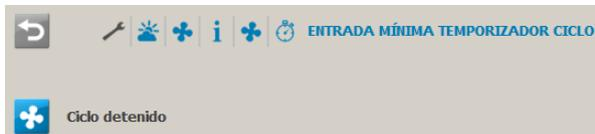
Cuando CT2 Touch regula la ventilación mínima con temporizador de ciclo, los obturadores se abren y cierran respectivamente. **Próximo cambio** indica cuánto tiempo queda hasta que el obturador cambie de posición.
