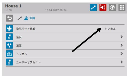
Viper Touchはこのメニューで現在システムが稼働中の換気の種類を表示します。
