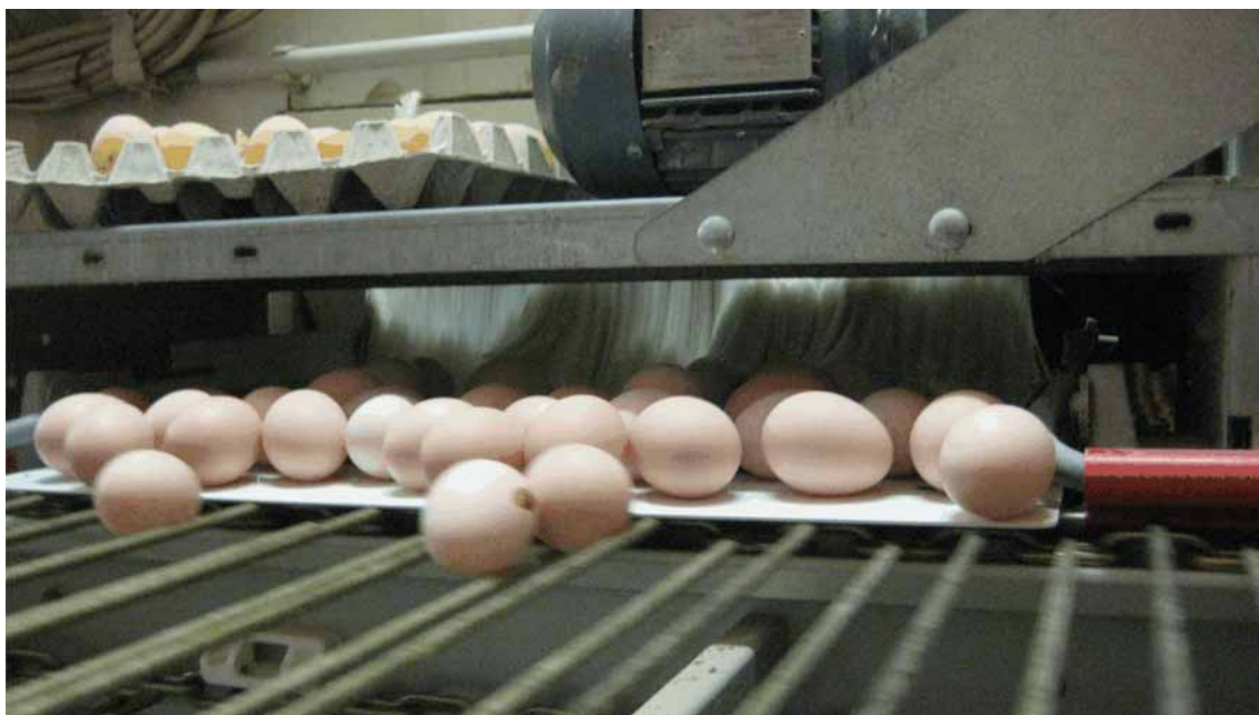
Slika 5-3: Prelaz iz gnezda na poprečni transporter
