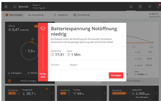
Der Stallcomputer zeichnet den Alarmtyp und die Uhrzeit auf, zu der ein Alarm auftritt.
