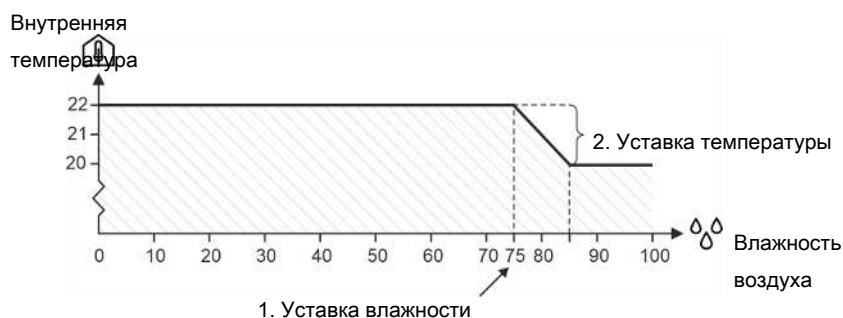
Рисунок 17: Управление влажностью со снижением температуры
