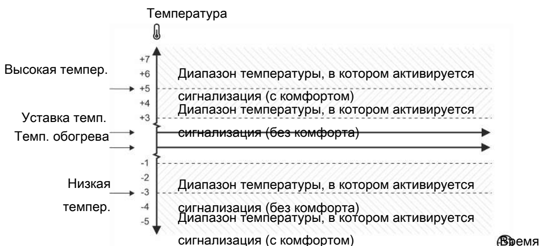
Рисунок 46: Сигнал высокой и низкой температуры
