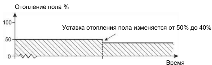
Рисунок 5: Обогрев пола без датчика температуры
