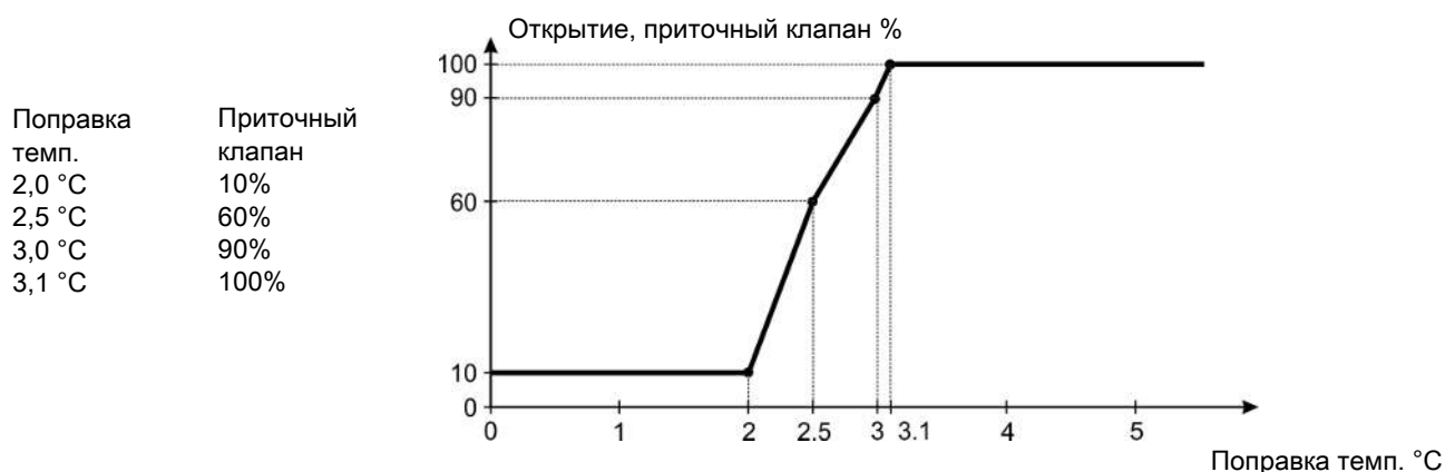
Рисунок 8: Комбидиффузный приточный клапан – бесступенчатое открытие согласно внутренней и внешней температуре
