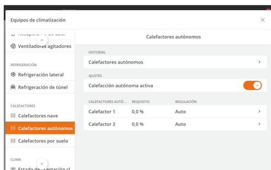
Puede utilizar hasta 4 calefactores autónomos a los que deberá asignar una zona local en la configuración del controlador.
