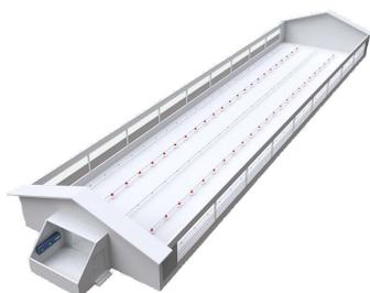
Con el sistema de ventilación natural, se produce un cambio de aire cuando las corrientes pasan entre la entrada de aire ajustable y la salida de aire sin la necesidad de utilizar ventiladores.
