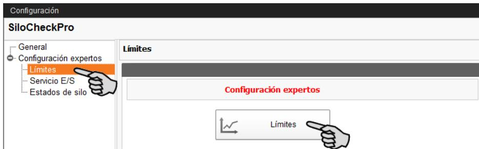
Se abre la ventana "SiloCheckPro - Límites". Los parámetros en negrilla describen las funciones de la aplicación SiloCheckpro.
