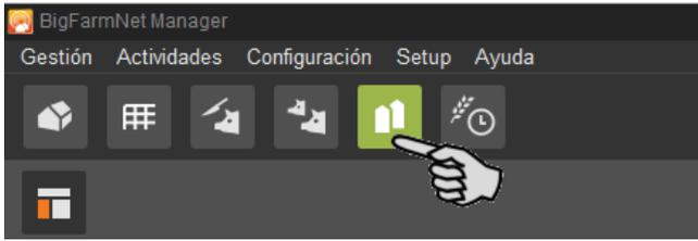
En la ventana de la aplicación, se abre la pestaña "Gestión de silos". La tabla muestra datos actuales de los silos:
