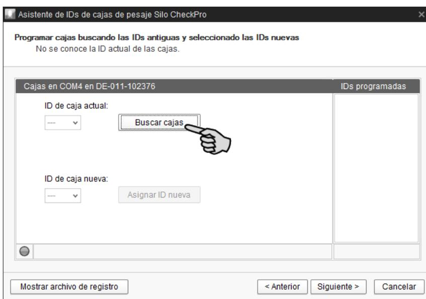
El asistente busca la ID de la caja de pesaje conectada. Se comprueban todos los números de 01 a 89. Verá el progreso de la búsqueda en la barra debajo de la ventana "IDs programadas". Una vez encontrada la ID existente de la caja de pesaje, la ID se muestra debajo de "ID de caja actual".
