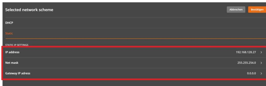
6. Введите для компьютера управления установленный IP-адрес. Чтобы закончить ввод данных, нажмите на кнопку **Confirm**.
