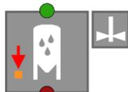
Бункер для жидких добавок, мешалка и мин. датчик
