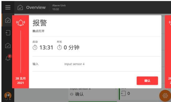
报警装置以弹出的方式显示报警。
