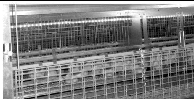
Obrázek 5-3: Prostor pro ustájení kuřat ve 2. etáži mezi krmným korytem a kapátkovou napáječkou
