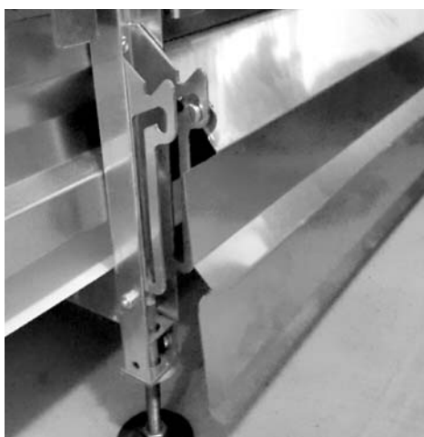
Obrázek 3-8: Sklopný zakončovací plech
