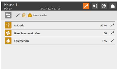
Esta función mantendrá el cambio de aire en la nave al permitir que la ventilación funcione a un porcentaje fijo (50 %) de la capacidad del sistema. De esta manera, se protege a los animales en el caso de que se establezca una nave como **Nave vacía** por error. Puede ajustar la calefacción para mantener el calor en la nave.
