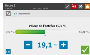
Lorsqu'une icône est grisée, cela signifie qu'aucune donnée n'est disponible pour la fonction. Autrement dit, un capteur est déconnecté.
