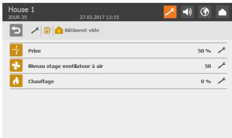
Cette fonction permet de maintenir le taux de recyclage de l'air du bâtiment en permettant à la ventilation de fonctionner à un pourcentage fixe (50 %) de la capacité du système. Ceci permet de protéger les animaux au cas où un bâtiment serait réglé sur **Bâtiment vide** par erreur. Vous pouvez régler le chauffage pour maintenir la chaleur du bâtiment.
