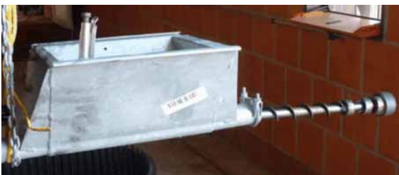
Bild 6-24: Spirale mit Gripzange fixieren
