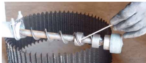
Bild 6-25: Spirale von Spannwellen lösen
