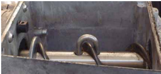
Bild 6-9: Spirale am Antrieb befestigen
