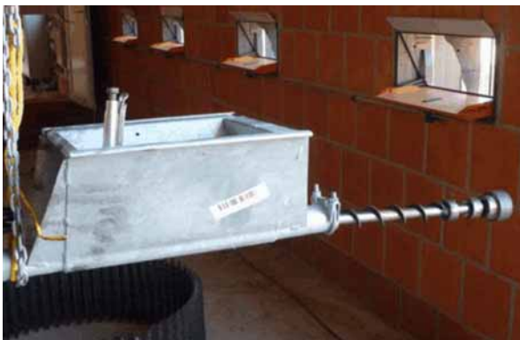
Bild 6-26: Spirale an Spannwellen
