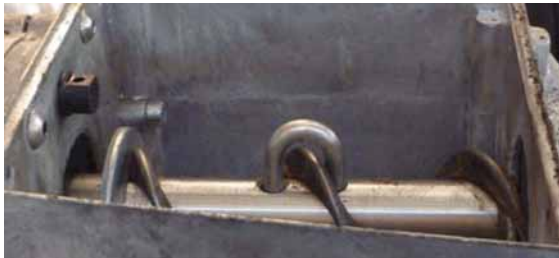
Bild 6-21: Spirale am Antrieb befestigen
