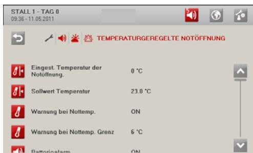
Nju valja namjestiti na stupanj temperature za koji **Temperatura otvaranja u nuždi** smije prekoračiti **Namještenu temperaturu** prije nego što računalo aktivira upozorenje.
