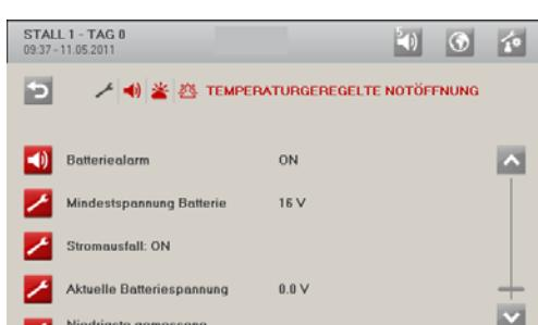
Klimatizacijsko računalo može aktivirati alarm ako baterija koja napaja jedinicu za otvaranje u nuždi ne funkcioniira. Tu funkciju moguće je uključiti i isključiti.
