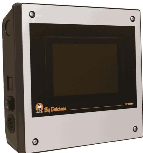
O sistema de alimentação EasySlider é comandado pelo computador de controlo 510pro com ecrã tátil. O 510pro tanto pode ser operado de forma central, por meio do BigFarmNet Manager, como também de forma descentralizada. Com o 510pro podem ser controladas no máximo 25 caixas de ligação CAN-Bus. Por caixa de ligação CAN-Bus podem ser criadas até 16 unidades EasySlider. Desta forma é possível controlar um máximo de 400 locais de alimentação EasySlider por meio de um 510pro.
