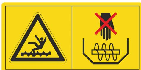
**Perigo de aprisionamento através de distribuidores, correntes ou roldana em funcionamento!**
