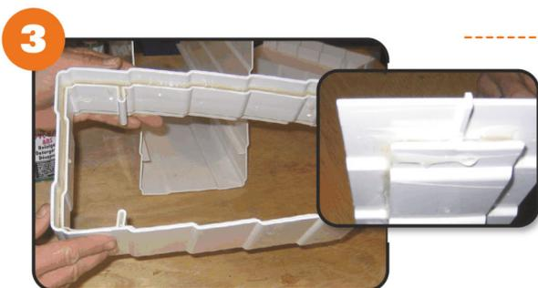
3. Vire o acoplamento e preencha **completamente** a fenda do outro lado com cola Tangit.
