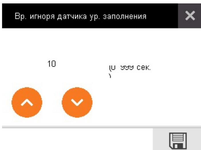
Рис. 5-12: Время игнорирования датчика уровня заполнения
