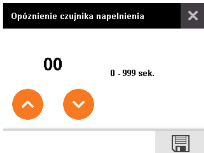
Rys. 5-13: Opóźnienie czujnika napełnienia
