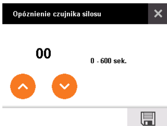
Rys. 5-20: Opóźnienie czujnika silosu
