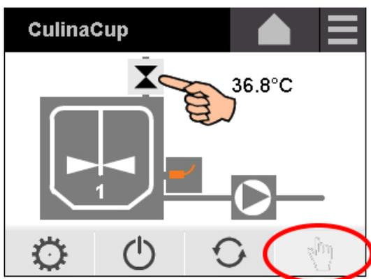
2. Mantenga pulsado el botón de la válvula de agua hasta que se abra la ventana **Tiempo de dosificación de agua manual**.
