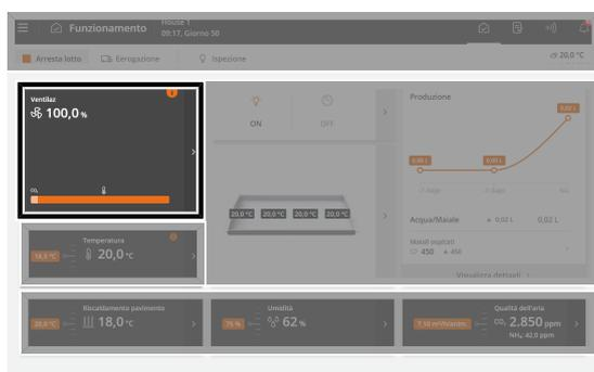
**Funzionamento.** I valori di ventilazione più importanti possono essere visualizzati e regolati tramite la scheda **Apparecchiatura climatica**.
