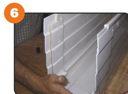
6. Acople **a continuación** el depósito y la pieza de unión. Para esta sección se necesitan **dos personas**.
