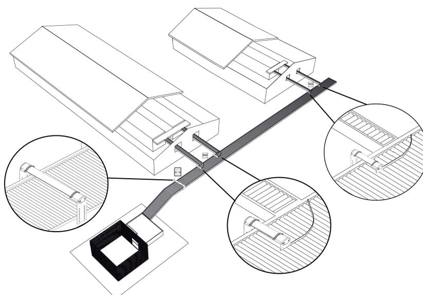
Figura 16: Dibujo esquematizado de la ubicación de los contadores de huevos automáticos.
