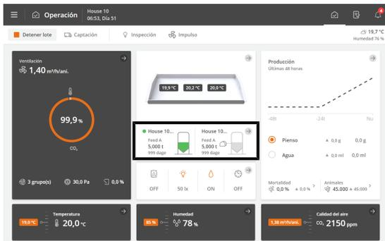
Cuando un silo se comparte entre varias naves, es regulado por un controlador maestro. Seleccione el controlador maestro y los controladores cliente durante la instalación.
