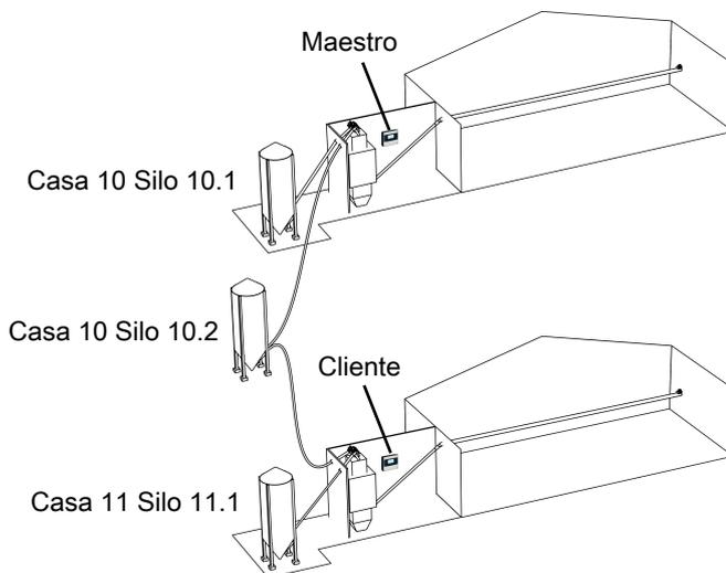
Figura 14: Ejemplo de silo compartido entre dos naves con controladores en LAN.
