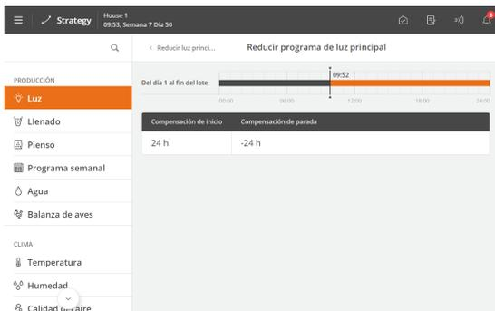
**Iniciar compensación y Detener compensación** se debe establecer durante el tiempo ON del programa de luz.
