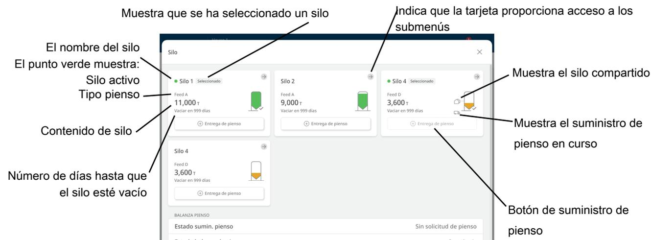
La tarjeta de silo muestra el estado de cada silo y recopila información y ajustes relevantes.
