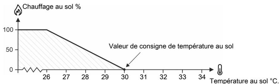
Figure 37: Chauffage au sol avec capteur thermique
