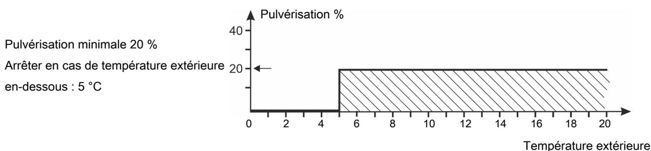
Figure 29: Pulvérisation conformément à la température extérieure
