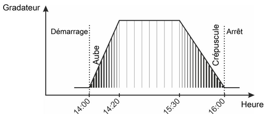
Figure 40: Gradateur normal d'éclairage Aube et crépuscule sont intégrés dans la période d'éclairage.
