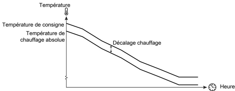
Figure 34: Définir le décalage chauffage
