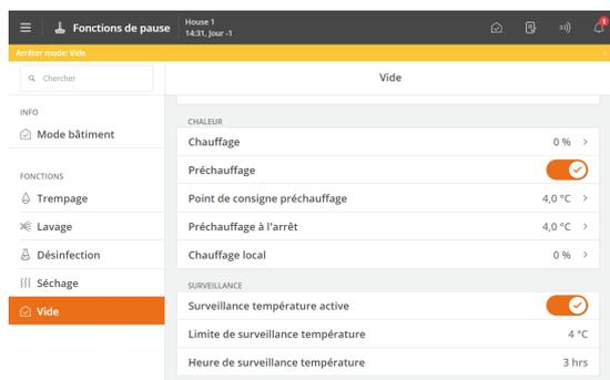
Le contrôleur peut être protégé contre un réglage incorrect de l'état du bâtiment sur **Vide**.
