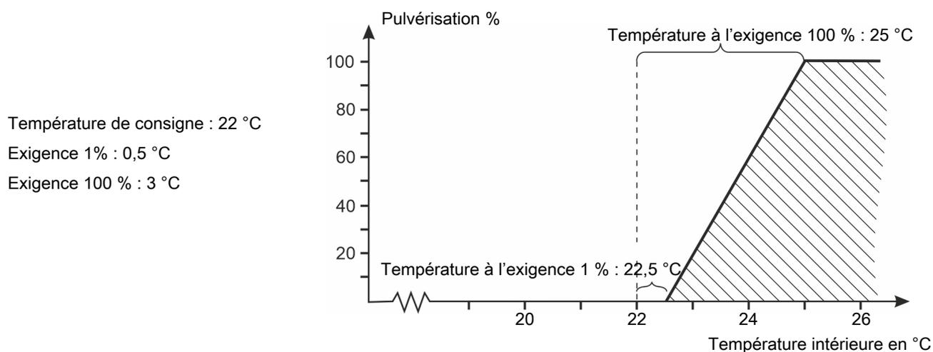
Figure 28: Pulvérisation conformément à la température intérieure
