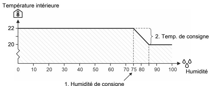
Figure 12: Contrôle de l'humidité avec réduction de température
