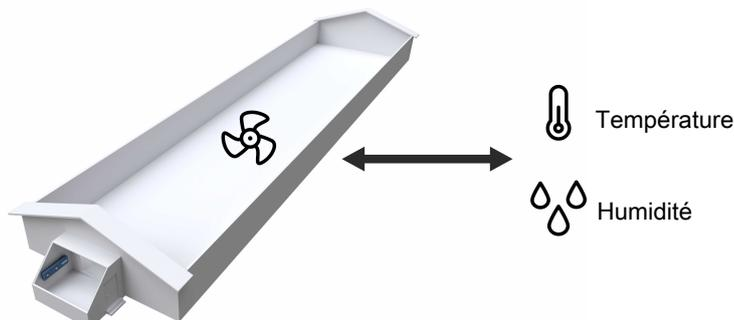
Le degré de ventilation est déterminé en fonction de 3 paramètres :
