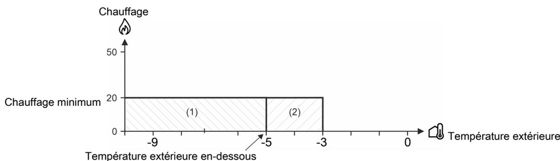
Figure 36: Chauffage minimum en cas de diminution ou d'augmentation de la température extérieure
