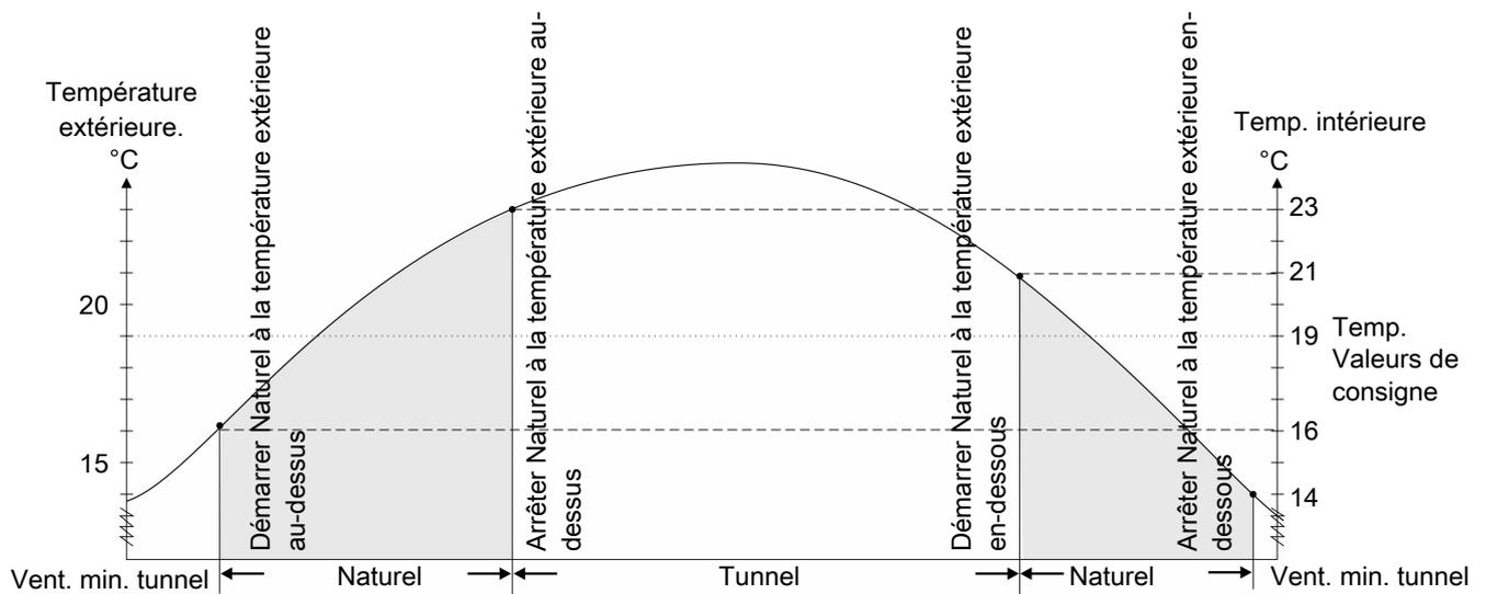
Figure 20: La ventilation naturelle est active en fonction de la température extérieure actuelle. La température de consigne est de 19 °C.
