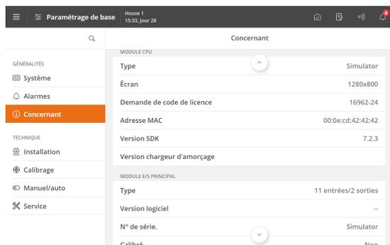
De plus, sous **module CPU**, vous pouvez voir le code de commande de licence, qui doit être utilisé lors de la commande de logiciels supplémentaires, par exemple, des modules complémentaires de production.
