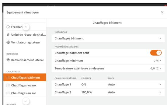
Le chauffage minimum est une fonction que le contrôleur active par temps froid. Le chauffage minimum peut par exemple réduire la formation de glace dans la prise d'air. Lorsque la température extérieure est réglée sur **Température extérieure en-dessous**, le contrôleur ajoute constamment la chaleur minimum.
