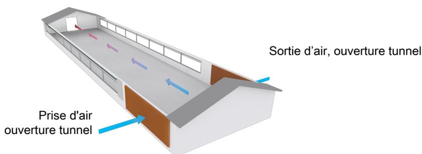
Figure 19: Exemple de bâtiment d'élevage avec la ventilation naturelle en association avec la ventilation tunnel, Ventilation tunnel.
