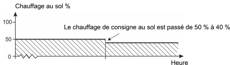
Figure 38: Chauffage au sol sans capteur thermique
