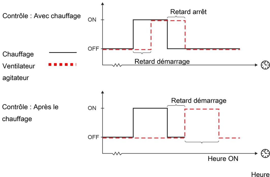
Figure 24: Contrôle avec chauffage
