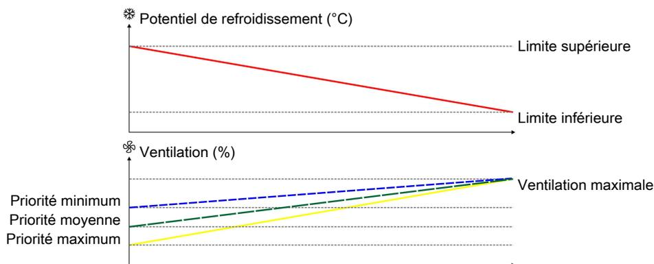
Figure 27: Plus le potentiel de refroidissement est élevé, plus la priorité de démarrage anticipé du refroidissement est élevée.
