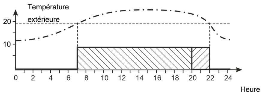
Figure 31: Pulvérisation conformément à l'heure et à la température extérieure
