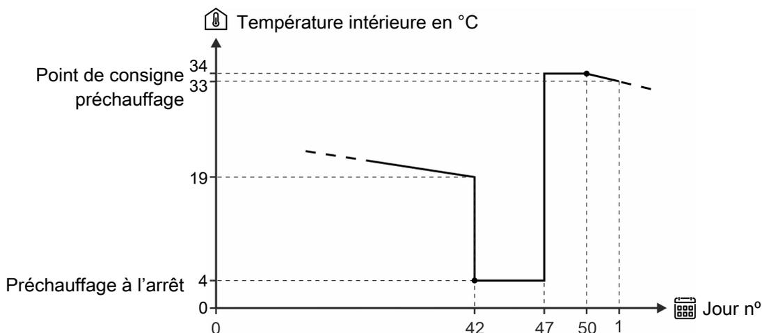
Figure 39: Exemple de paramétrage du préchauffage.
