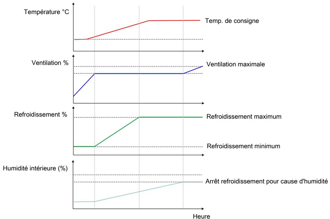
Figure 26: Pour maintenir la température intérieure requise, le refroidissement démarre avant que le niveau de ventilation n'ait atteint la ventilation maximale. Lorsque le refroidissement ne peut plus maintenir la température, la ventilation est augmentée à nouveau.
