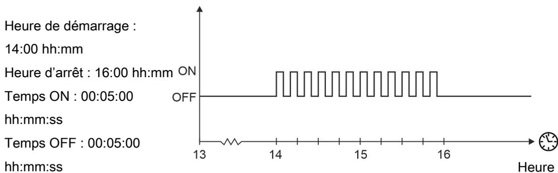
Figure 23: Contrôle de l'horloge de 24h
