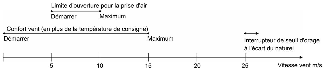
Figure 22: Ventilation naturelle à des vitesses du vent en augmentation
