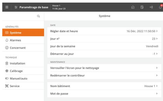
Lorsque le contrôleur doit être nettoyé, il est possible de verrouiller l'écran pour éviter le fonctionnement accidentel pendant le nettoyage.
