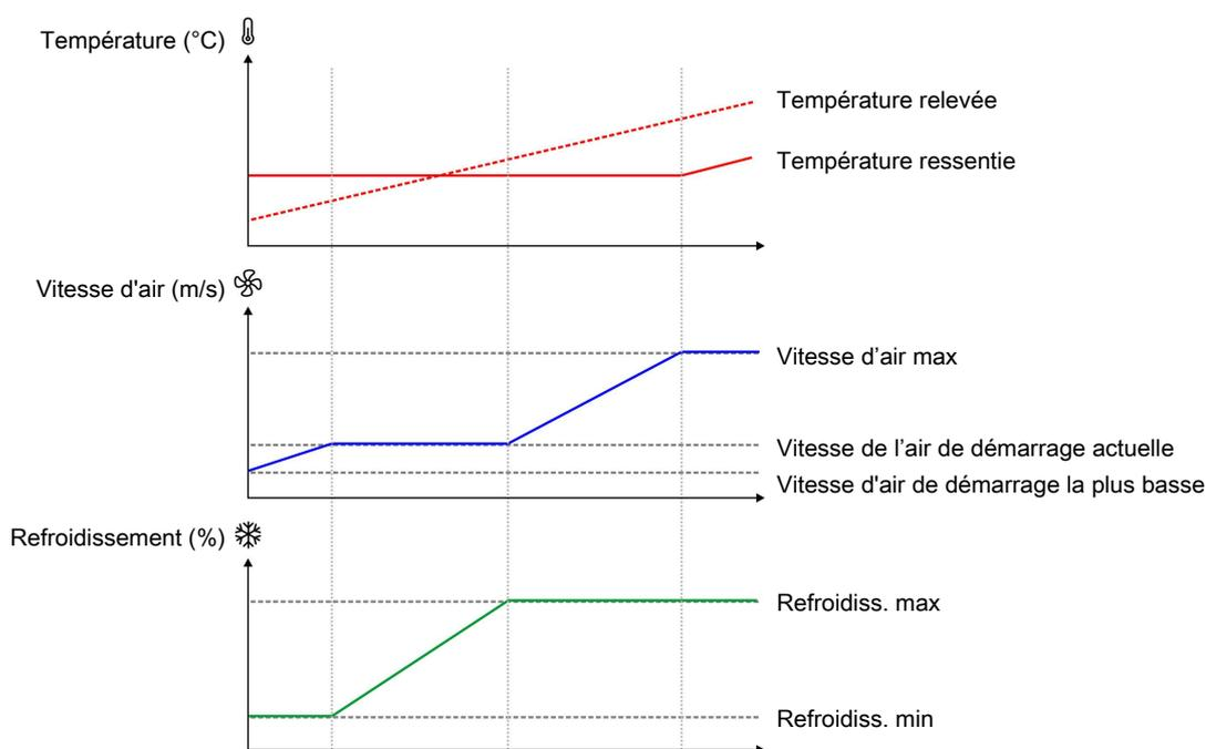
Figure 33: Le refroidissement démarre déjà à une vitesse d'air basse afin de maintenir la température intérieure requise. Lorsque le refroidissement ne parvient pas à maintenir la température, la vitesse d'air est de nouveau augmentée.
