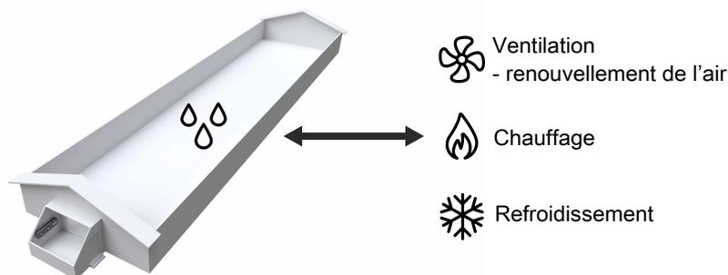
L'humidité contenue dans le bâtiment provient en partie des animaux, des aliments, de l'eau potable et de la litière, et en partie des fonctions de refroidissement et d'humidification.
