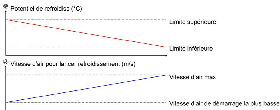
Figure 32: Dans les zones à faible humidité extérieure et à fort potentiel de refroidissement, le refroidissement peut commencer à une vitesse d'air plus faible. Dans les zones à faible potentiel de refroidissement, le refroidissement démarre le plus tard possible, ce qui signifie qu'il démarre à une vitesse d'air maximum.
