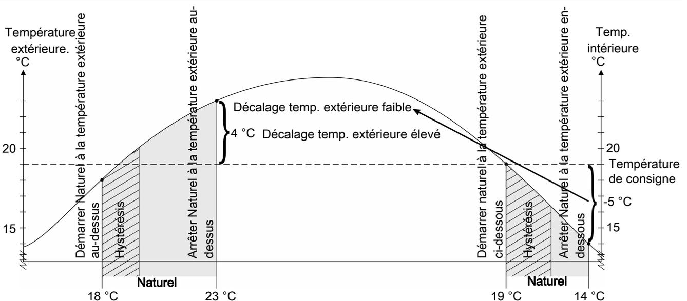
Figure 21: La ventilation naturelle est active en fonction de la température extérieure actuelle.
