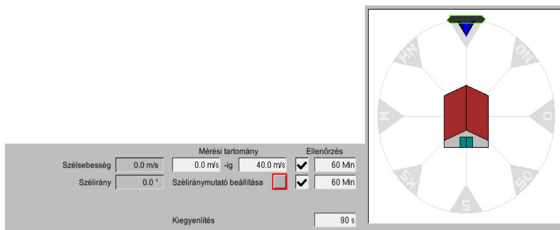
Kép 2-9: Időjárás-állomás kalibrálása
