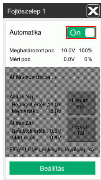
Kép 4-8: Analóg csappantyú visszajelzéssel
