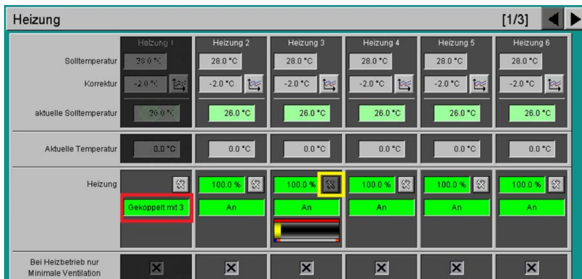
Kép 9-12: Fűtés csatlakoztatás aktív
