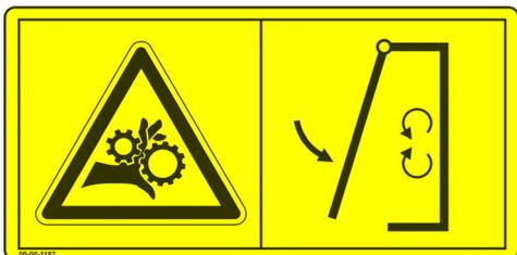
**Pericolo di schiacciamento dovuto ai pezzi rotanti della macchina!**
