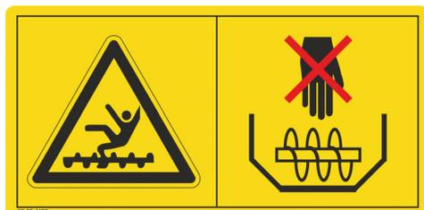
**Pericolo di trascinamento dovuto al funzionamento di vite senza fine, catena o pulegge!**
