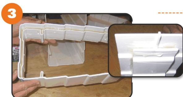
3. Ruotare il giunto e riempire la fessura sull'altro lato **completamente** con colla Tangit.
