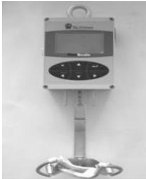
用链条将称重器悬挂于结实、无弹性偏斜的结构上。装上挂钩并按 $\times$ 键开机。
