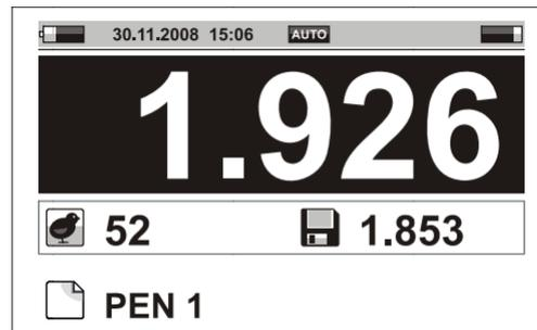
显示屏上的保存图标持续闪动直到移除所称物且保存图标旁显示的最后称重值被记入日志。
