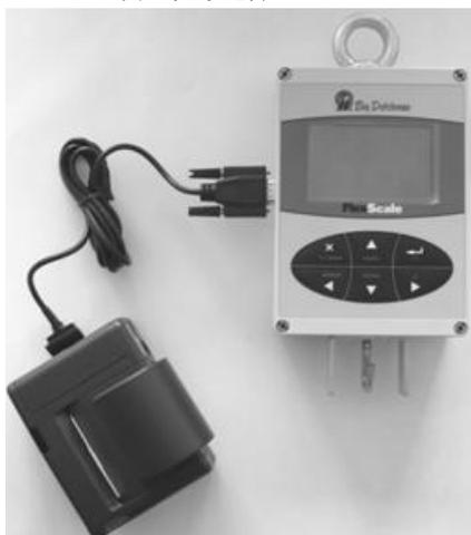
将打印机的数据线连接到称重器的 DB9 串行端口并启动打印机。
