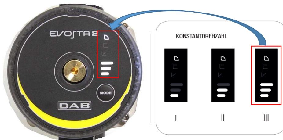
Durch 2x drücken auf die „MODE“ Taste kann zwischen den Programmen der Pumpe geschaltet werden. Stellen Sie die Pumpe auf „KonstantDrehzahl III“
