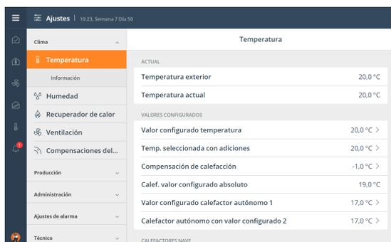
Puede utilizar hasta cuatro calefactores autónomos a los que deberá asignar una zona local en la configuración del controlador. El controlador de la nave regula la calefacción en las zonas locales de la misma, independientemente de la calefacción general de esta, y las calienta por medio de calefactores ubicados en cada zona.
