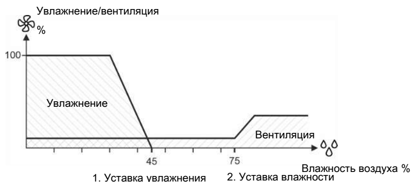
Рисунок 12: 1. Уменьшение влажности воздуха. Влажность воздуха ниже уставки увлажнения Контроллер помещения включает увлажнение. 2. Повышение влажности воздуха. Влажность воздуха выше уставки влажности. Контроллер помещения увеличивает вентиляцию.
