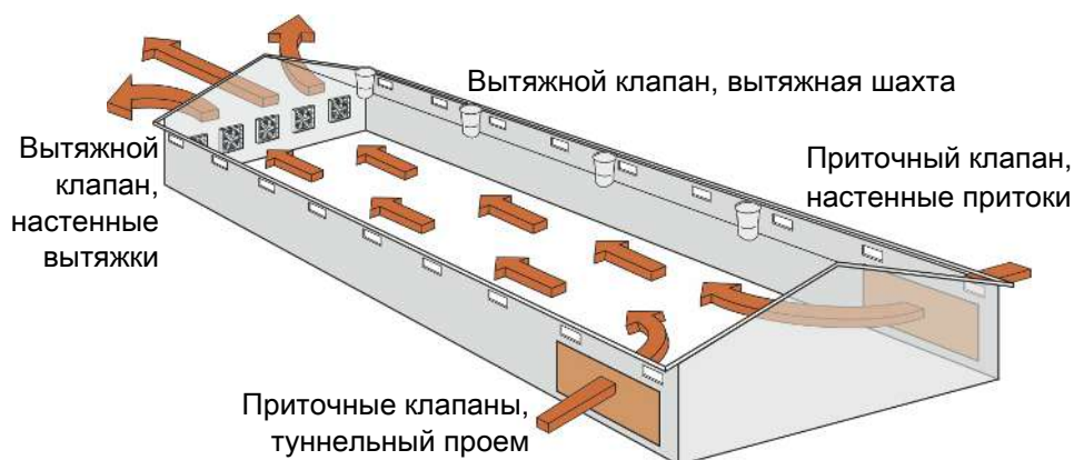
Рисунок 34: Поток воздуха в теории для туннельно-вытяжной система вентиляции.
